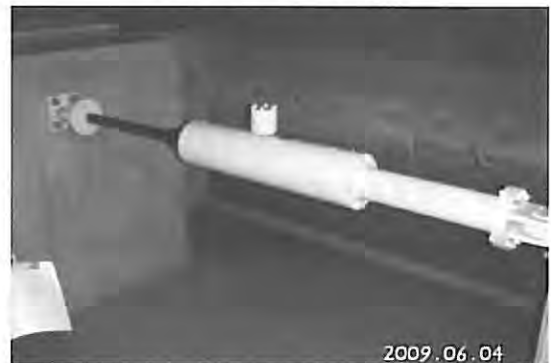
増幅機構付減衰装置4基
