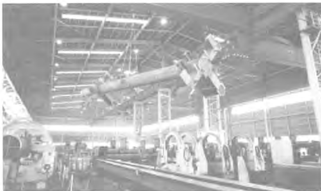
第二工場 天井走行クレーン (30 t)
